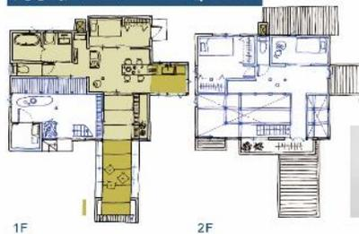
2階すべてと1階の南側をルームガーデンとし、断熱ゾーンは北面する。一方カートリッジが入きくとび出し大きく荷に開く
