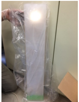
エアロゲル建具 熱貫流率 1.26 [W/m^2K]
